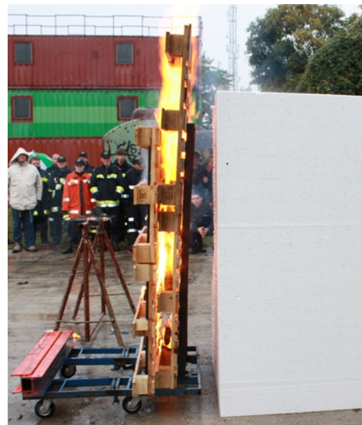
Foto: Brennende Holzpaletten vor Block aus Baustyropor
